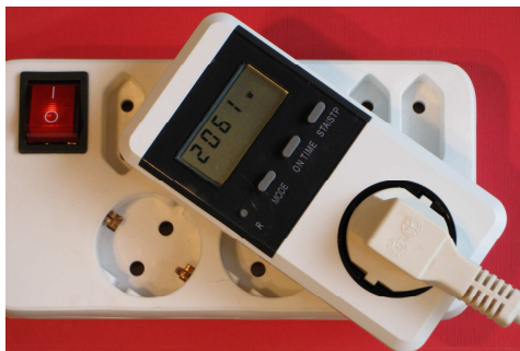
Strommessgerät im Einsatz
